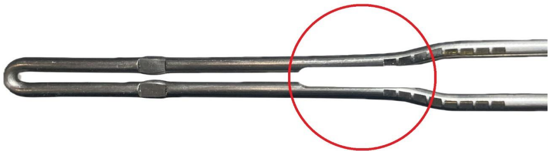
Abbildung 3: Modifizierte Abzugsgabel der Gen 1 – nicht für NATO-Version geeignet
